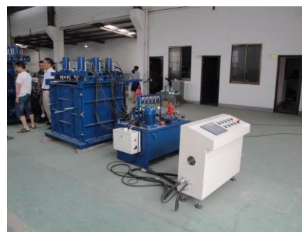
注浆模拟试验平台
